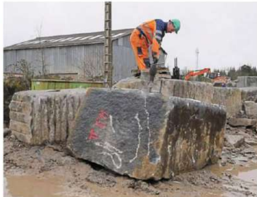
Pascal, employé de la Socal, utilise une méthode ancestrale pour fendre le bloc de granit : il enfonce des coins dans le bloc jusqu'à ce qu'il casse.
