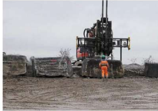
L'entreprise Socal a investi dans des nouvelles machines, plus performantes, trois ans avant la crise. Cette machine perfore les blocs de granit.
